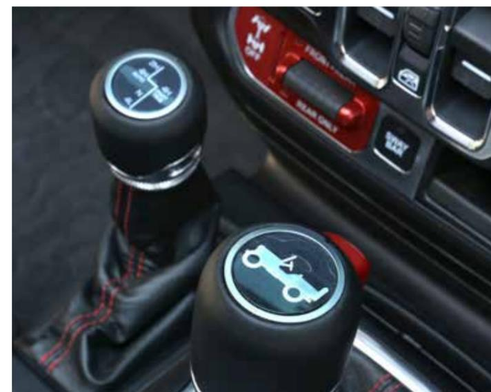
// **4L deaktiviert automatisch ESP und die Traktionskontrolle,** so dass man beim Klettern auf schlüpfrigem Grund nicht stehen bleibt. //
