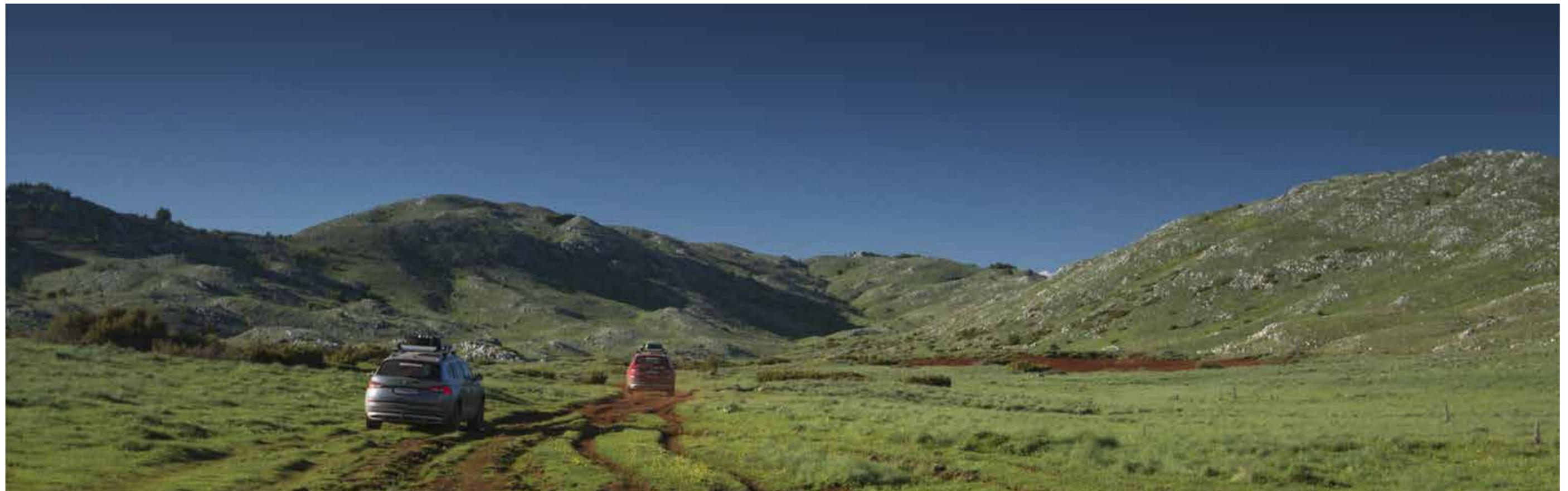
ein Rad in der Luft hängt. Die regelt zwar lediglich per Bremsengriff, aber doch effektiv. Eine harte Währung im Gelände sind grosse Böschungswinkel (19.1 Grad vorne und 15.7 Grad hinten) und Bodenfreiheit (194 mm). Damit keine Missverständnisse entstehen: Um wirklich unwegsames Terrain zu bezwingen, fehlt es dem Kodiaq natürlich an Rüstzeug, aber er schafft Wege, vor denen ein konventioneller PW längst kapituliert.
